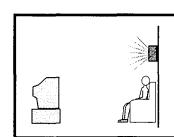
**Colocación alterna de los altavoces surround de canal posterior de la serie R.** Si no puede colocar los altavoces surround posteriores en las paredes laterales, colóquelos en la pared de atrás bien por encima del oyente.
