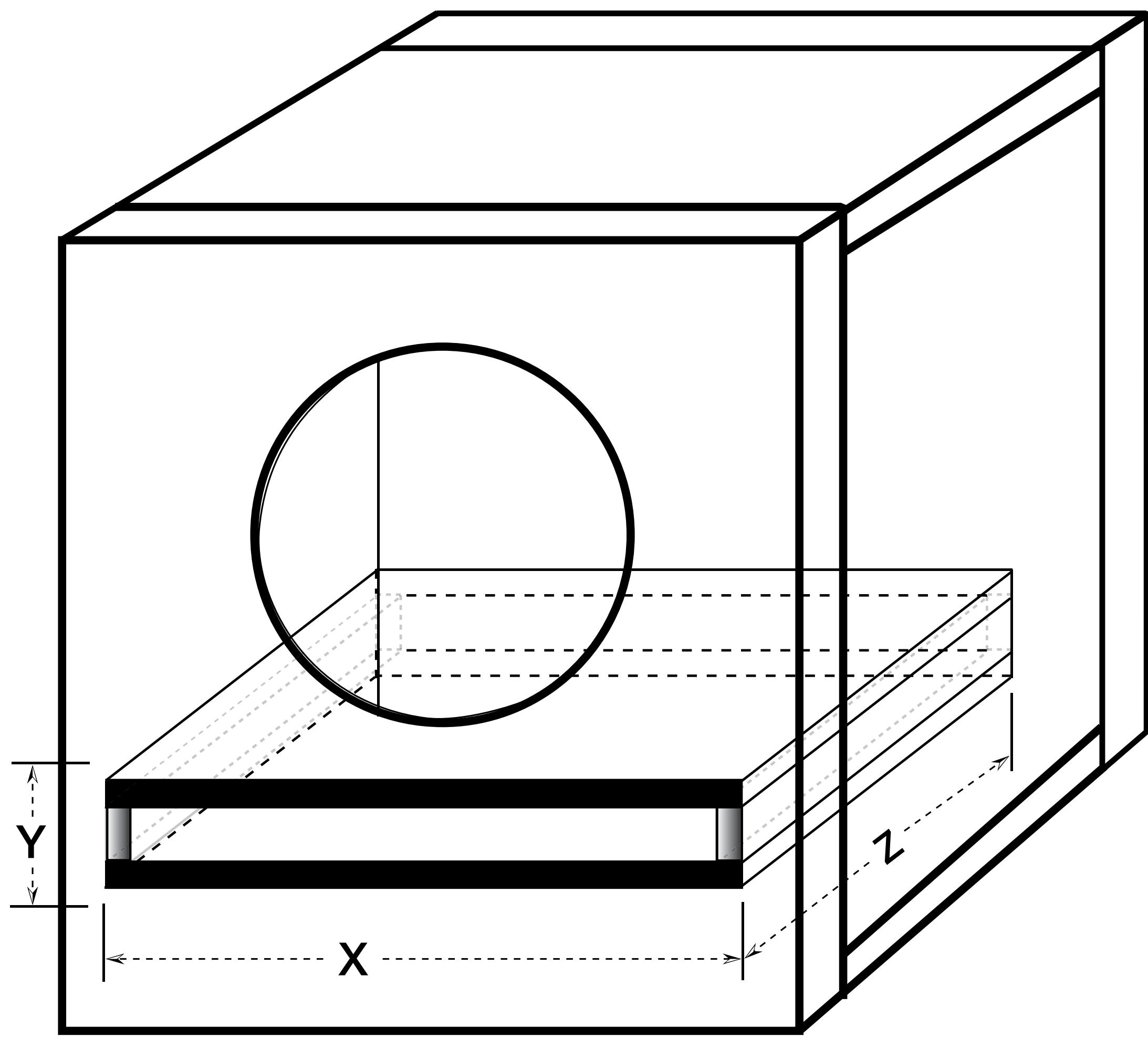
No instale una abertura de puerto sobre una superficie sólida, como un soporte interno, un panel posterior o una pared del maletero, asiento o panel interior de su vehículo. La abertura del puerto debe permanecer libre de obstrucciones. Utilice la dimensión más pequeño del puerto rectangular como la cantidad de espacio mínima entre la abertura del puerto y cualquier superficie sólida para garantizar un flujo de aire sin restricciones.
