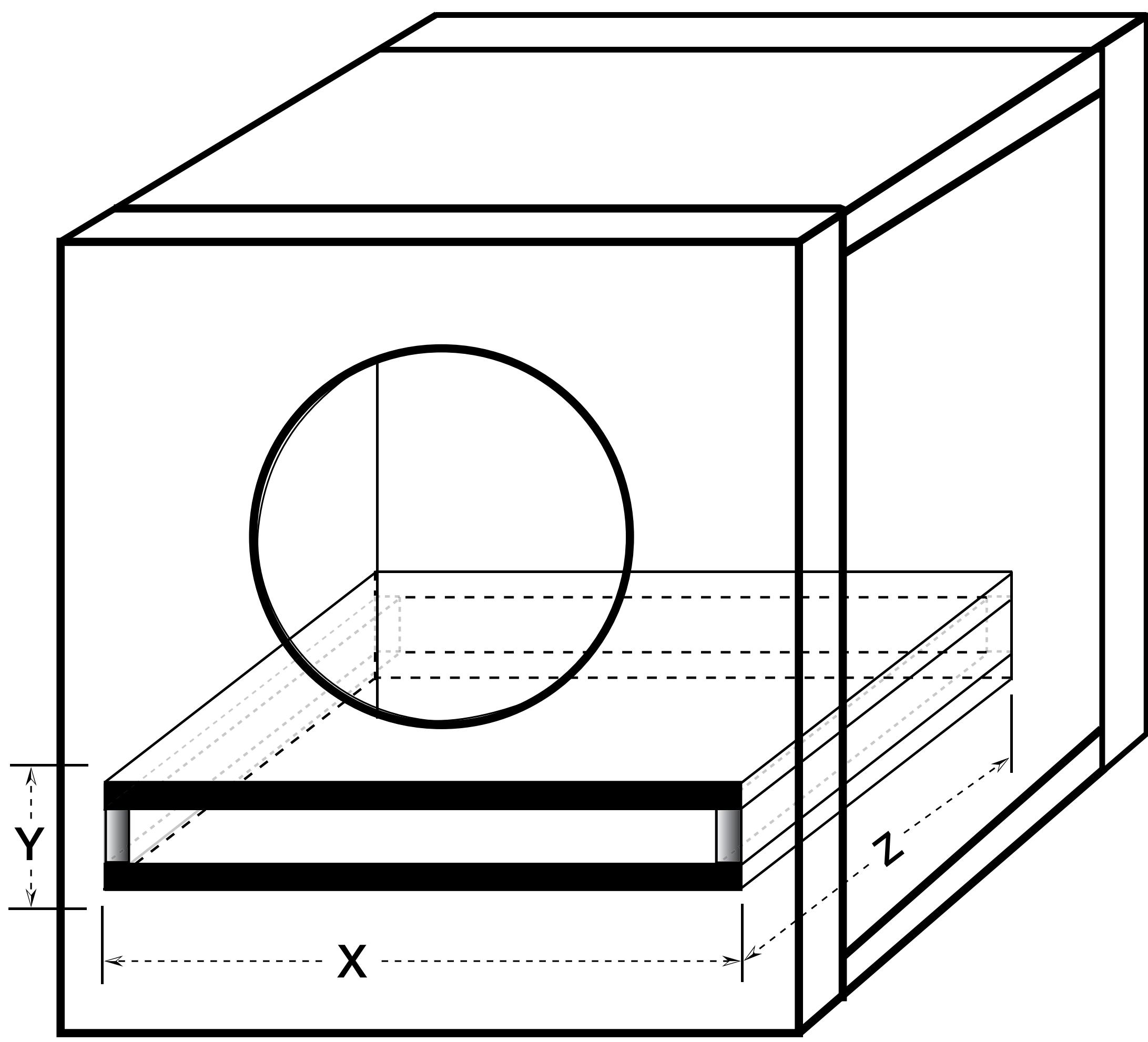
Installieren Sie eine Anschlussöffnung nicht gegen eine feste Oberfläche wie etwa eine innere Halterung, eine Rückwand oder eine Kofferraumwand, einen Sitz oder eine Innenwand Ihres Fahrzeugs. Die Anschlussöffnung muss frei zugänglich sein. Verwenden Sie die kleinste Abmessung des rechteckigen Anschlusses als den minimalen Abstand zwischen der Anschlussöffnung und einer festen Oberfläche, um eine freie Luftzirkulation zu gewährleisten.
